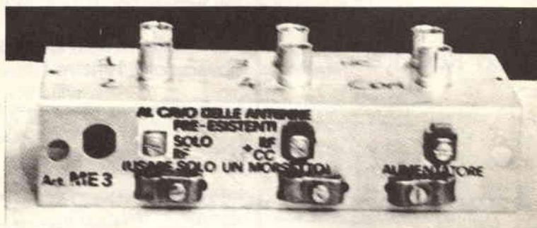
I connettori standard TV devono essere rimossi e sostituiti con bocchettoni S0239 anche se per alcuni usi (leggi SWL e BCL) possono anche essere utilizzati evitando così l'acquisto degli S0 e relativi PL e risparmiando ulteriormente sul costo finale della realizzazione.
