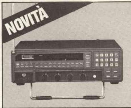
La ricerca può essere impostata ad arrestarsi in coincidenza ad una semplice portante o al tipo di modulazione richiesto. Gli incrementi sono di 5 o 6.25 KHz sino a 180 MHz e di 10 o 12.5 KHz dai 180 ai 520 MHz. Può esservi inserita un'apposita unità trasmittente che permette l'emissione entro una banda prescelta larga 4 MHz nella VHF e 10 MHz nelle UHF. La potenza RF è superiore ad 1W. Le possibilità e le applicazioni di questo apparato dipendono solo dalla fantasia dell'operatore!
